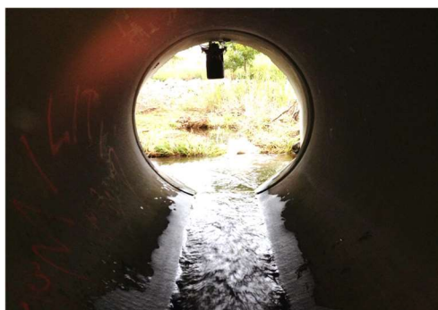
Obr. 6. Umístění bezkontaktního průtokoměru Isco LaserFlow
