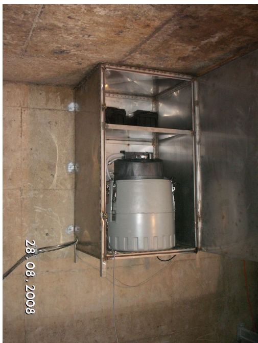
Obr. 2. Bateriové napájení vzorkovače v odlehčovací komoře – 2 x 80 Ah
